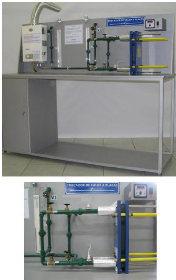
Figura 07. Fotos ilustrativas do experimento para determinação da transferência de calor a placas
