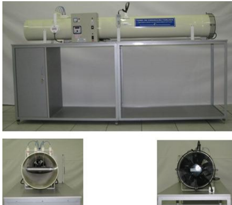
Figura 06. Fotos ilustrativas do experimento para determinação da transferência de calor por convecção forçada ao redor de corpos sólidos.
