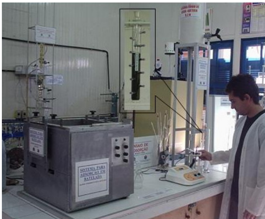
Figura 12. Foto ilustrativa do experimento de adsorção sólido-líquido e coluna batelada.
