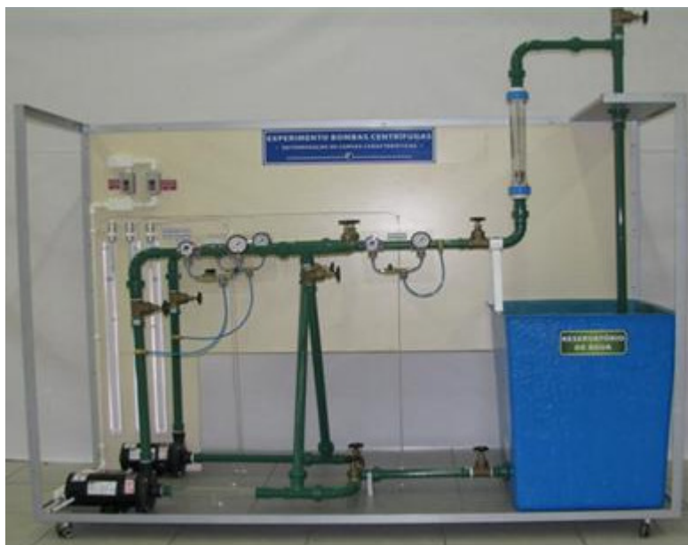
Figura 02. Foto ilustrativa do experimento para determinação de curvas características e associação de bombas centrífugas.
