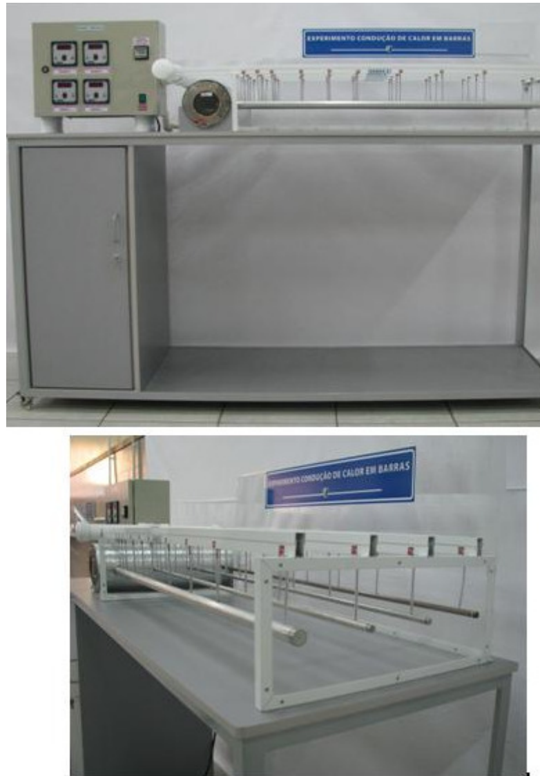
Figura 05. Fotos ilustrativas do experimento para determinação da transferência de calor por condução em barras metálicas e por convecção natural para o ar.
