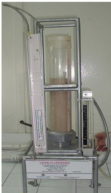
Figura 04. Foto ilustrativa do experimento para determinação de perda de carga em escoamentos por meios porosos e fluidização sólido-gás.
